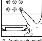
10. Après avoir rempli le réservoir d'eau, appuyez sur le bouton de nettoyage de la membrane transductrice/ultrasonique jusqu'à ce que l'indicateur de nettoyage s'éteigne.
