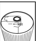
3. Llenar con agua del grifo o agua destilada (si se encuentra en un área con agua dura) hasta que el nivel de agua alcance la línea de llenado MAX. NO llenar usando agua tibia o caliente. **PRECAUCIÓN:** Nunca agregue aceites esenciales u otros aditivos al tanque de agua o al depósito de agua. Consulte la sección sobre cómo usar correctamente aceites esenciales con este humidificador.
