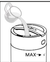
2. Llene el tanque con agua limpia y fresca o agua destilada (si se encuentra en un área con agua dura) hasta que el nivel de agua alcance la línea de llenado MÁX. **NOTA:** No llenar más allá de la línea de llenado MÁX.
