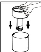
4. Coloca el cartucho de desmineralización empapado en el tanque de agua. Vuelve a colocar la cubierta superior asegurándose de que esté bloqueada firmemente al tanque de agua.
