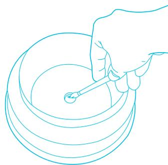
Pour un nettoyage en profondeur, versez une solution d'eau et de vinaigre (50/50) dans le réservoir et laissez-la pendant 5 minutes. Brossez les parois du réservoir, le socle et la membrane ultrasonique avec une brosse douce (non incluse) et rincez. **NE TOUCHEZ JAMAIS** la membrane ultrasonique avec les doigts, car l'huile naturelle de la peau peut endommager la membrane.
